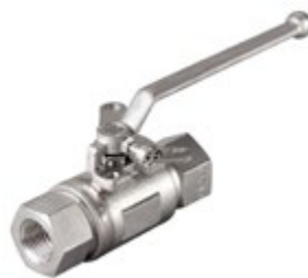
Válvula de bola de 2 piezas: 1/4" a 2" 3600 WOG Sello soldado, Extremos roscados
